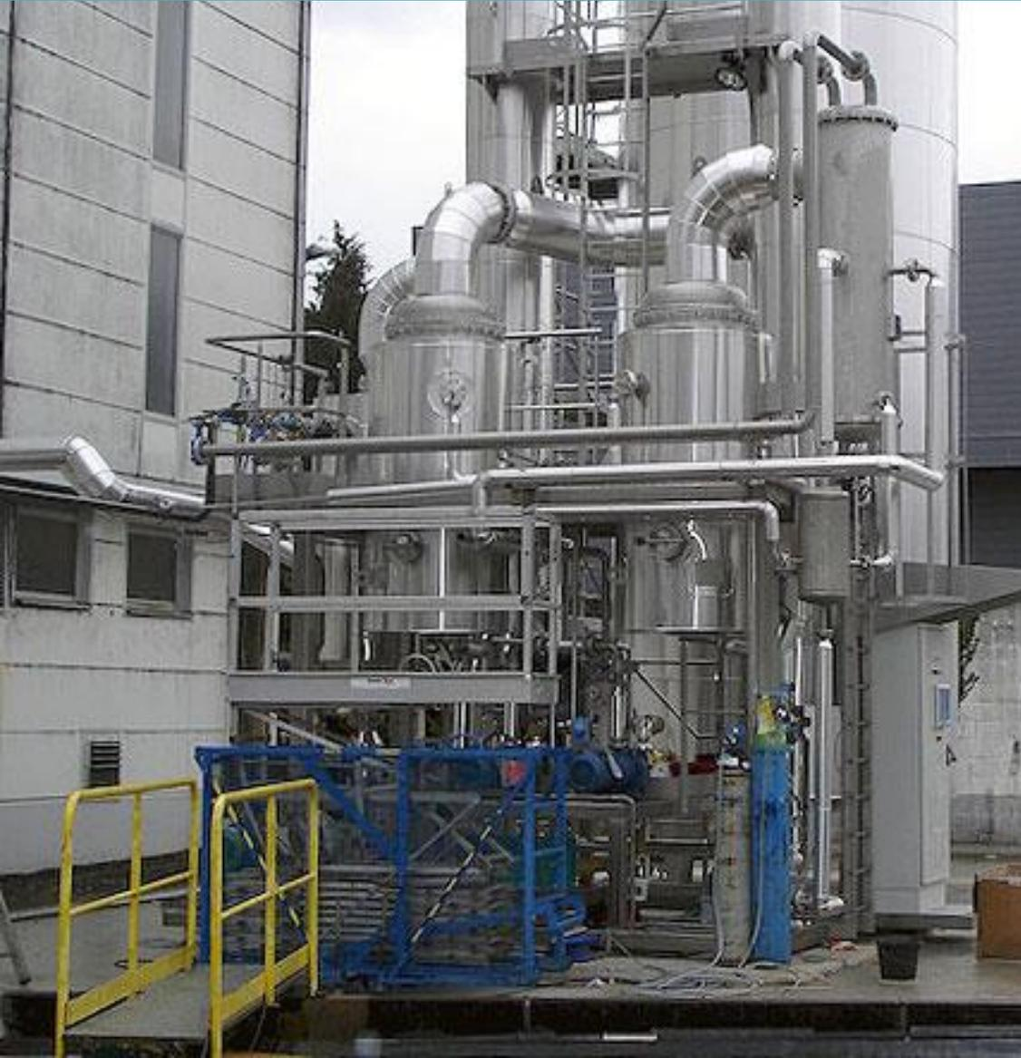
*Remplacement d'un évaporateur standard par une compression mécanique de vapeur*
